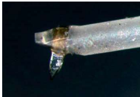
Bild 3 und Bild 4: Nadel vor der Reinigung (links) und danach (rechts)]
