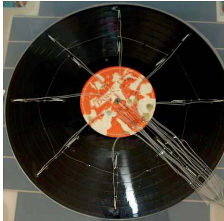
Mess-LP mit 17 eingegossenen Sensoren*
