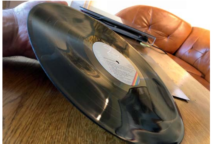
Durch Sonneneinstrahlung verformtes Vinyl***
