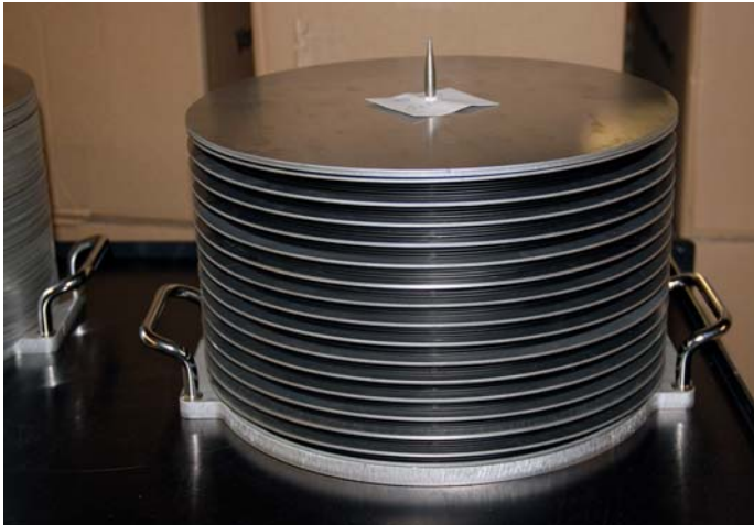
Abkühlvorgang von Schallplatten nach dem Pressen
