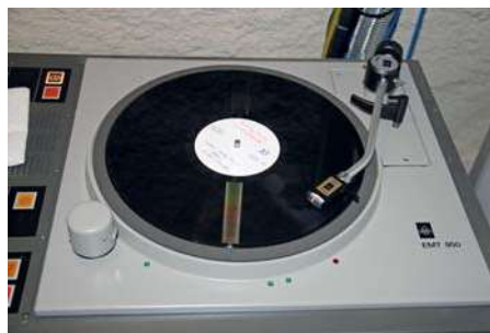
Bild 7: Testplatte auf dem EMT 950 bei Pauler Studios mit dem handbeschrifteten Label der Vorserie
