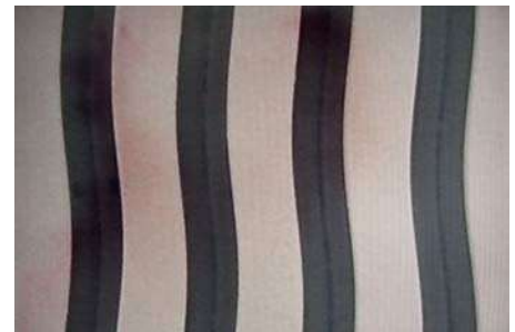
Bild 9: Die 1 kHz Stereorille in Großaufnahme
