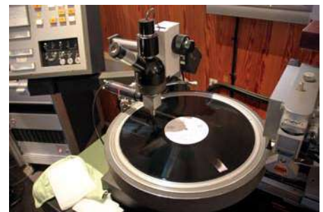
Bild 8: Testplatte TLP-1 auf dem DMM-Schneidegerät zur Begutachtung der Oberfläche
