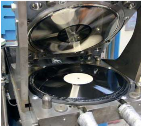
Bild 4: Die erste Testplatte (hier noch mit weißem Etikett), wie sie aus der Pressmaschine kommt
