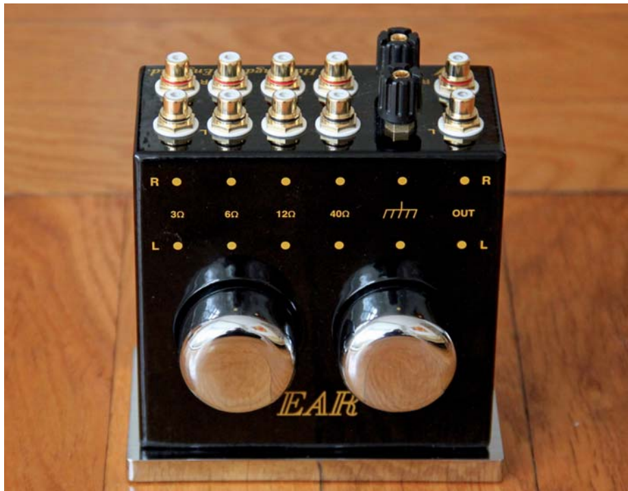
Bild 4: Gehäuseaufdruck der Anschlussimpedanzen
