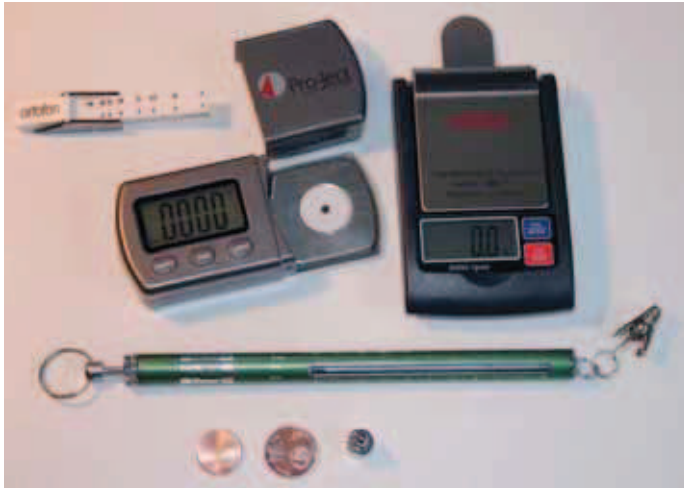
Bild 2: Übersicht aller Messgeräte und der Referenzgewichte
