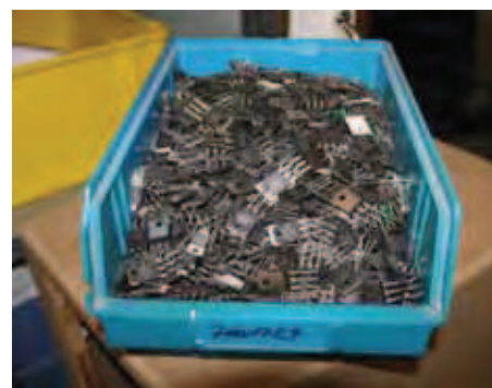
Produktpflege: Ausgetauschte Endstufentransistoren aus dem PA50 Igel.
